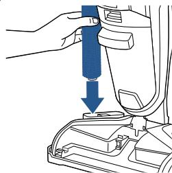
Установите щеточный валик вертикально на предназначенную для него поставку для сушки.
