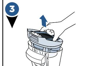
Возмите крышку емкости за углубления, имеющиеся на обеих сторонах фильтра, и извлеките ее из емкости движением «вверх».
