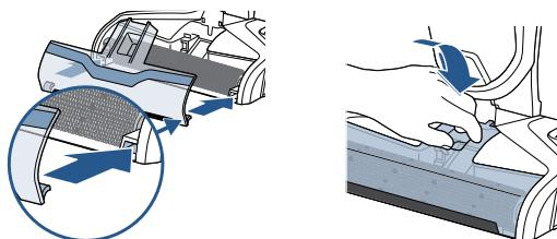
Установите прозрачную накладку для щеточного валика на место, предварительно выровняв имеющиеся на ней язычки по пазам, имеющимся в основной насадке. Вставьте язычки в пазы и нажмите на прозрачную крышку так, чтобы раздался щелчок.
