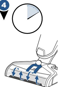
Каждый раз перед началом использования пылесоса нажмите и удерживайте курок распыления раствора в течение 10 секунд, чтобы подкачать чистящий раствор в систему. При нажатии на курок загорятся светодиодные индикаторы.
