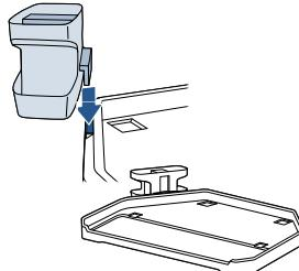
Лоток для легкой очистки и хранения состоит из лотка для хранения пылесоса и подставки для сушки щеточного валика. Чтобы собрать лоток для легкой очистки и хранения, совместите стрелки на лотке для хранения со стрелками на подставке для щеточного валика и вставьте подставку в лоток.
