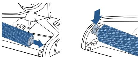
Установите щеточный валик на место, вставив его сначала в правую часть основной насадки, а затем слегка нажав на выступ так, чтобы зафиксировать валик.
