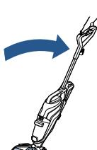
Наклоните пылесос, установленный на лоток для хранения, назад. Дайте пылесосу поработать 10–15 секунд, пока не будет собрана вся вода. При необходимости повторите данную процедуру.
