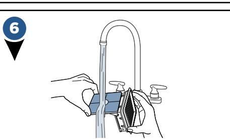
Вымойте фильтр и сетку вручную теплой водой с мягким моющим средством.
