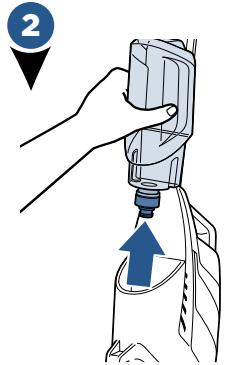
Чтобы снять ёмкость для чистой воды с пылесоса, поднимите ее вверх.
