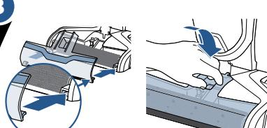
Установите прозрачную накладку для щеточного валика на место, предварительно выровняв имеющиеся на ней язычки по пазам, имеющимся в основной насадке. Вставьте язычки в пазы и нажмите на прозрачную крышку так, чтобы раздался щелчок.
