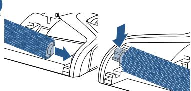
Установите щеточный валик на место, вставив его сначала в правую часть основной насадки, а затем слегка нажав на выступ так, чтобы зафиксировать валик.
