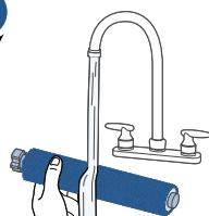
Промойте щеточный валик и его прозрачную накладку теплой водой.
