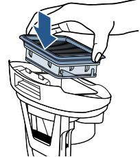
Вставьте фильтр обратно в крышку емкости для грязной воды.
