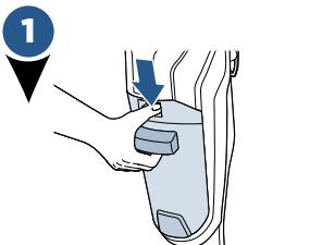
Чтобы снять емкость для грязной воды, нажмите кнопку, утопленную в крышке емкости.
