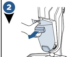
Нажав эту кнопку, потяните емкость для грязной воды на себя за имеющуюся на ней ручку и снимите ее с пылесоса.
