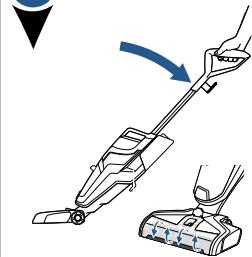
Наклоните корпус пылесоса назад; при этом начнет вращаться щеточный валик. Чтобы остановить его вращение, потребуется перевести корпус пылесоса в вертикальное положение.
