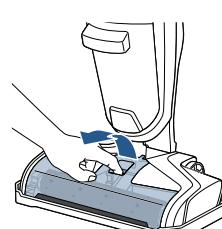
Снимите прозрачную накладку щеточного валика, потянув ее верхнюю часть на себя.
