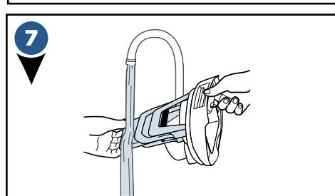
Ополосните поплавок, установленный в нижней части крышки емкости для грязной воды.
