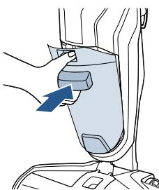
Держа емкость для грязной воды под углом к корпусу пылесоса, сначала вставьте ее дном в предназначеннное для нее углубление. Затем прижмите верхнюю часть емкости к корпусу пылесоса и зафиксируйте ее так, чтобы раздался щелчок.
