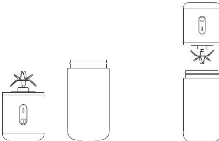
Нажмите последовательно два раза на кнопку включения и переверните блендер. Не включайте уже перевернутый блендер, так как может возникнуть перегруз-
