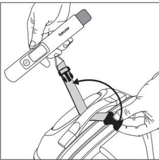
**DE** Ziehen Sie den Gurt der Kofferwaage durch den Griff Ihres Gepäckstücks. Befestigen Sie den Clip.
